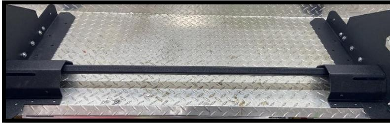
4- Prendre le Cap Hexagonal. **Remarquer les deux encoches se retrouvant sur le cap hexagonal.** Déposer le cap hexagonal sur les deux sorties hexagonales en prenant bien attention de mettre les encoches vis-à-vis les ouvertures sur les sorties hexagonales.
