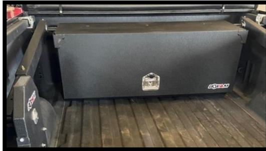
19- Envoyer les bras vers le coffre à l'aide de la poignée de commande. Enligner les bras de façon qu'ils soient vis-à-vis les trous sur les côtés du coffre qui serviront à attacher les bras au coffre. Ensuite, prendre les **4** boulons 5/16 avec rondelle et écrou en nylon pour boulonner les bras avec le bon ajustement. Deux de chaque côté. Prendre les trous les plus accessibles pour vous et boulonner avec 5lb/pied de serrage.
