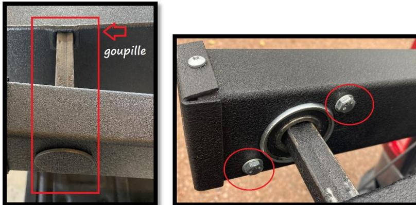
24- Avant d'insérer la goupille du côté droit du coffre, s'assurer que la plaquette qui est conçue pour attacher le tube d'auto-nivellement à la goupille est dans la bonne position (trou percé vers le haut), et insérer la goupille. (S'assurer que les deux boulons du roulement (bearing) sont louses à ce moment, afin de permettre un meilleur ajustement de la goupille).
