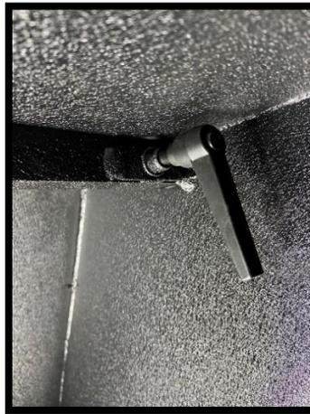
29- Les interrupteurs de fin de course (limit switch) servent à ce que la manette soit désactivée lorsque le coffre est déposé à l'une de ses deux positions. De cette façon, lorsque le coffre se dépose et que même si le bouton est enfoncé, le coffre arrête sa course directement.
